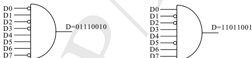
Figura 5.28: Uma porta lógica E como comparador de igualdade com as constantes  $01110010_2$  e  $11011001_2$ .
